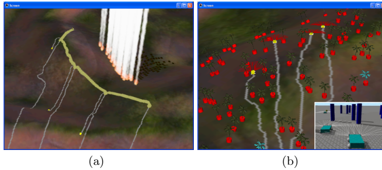
Figura 4. (a) Resultado satisfatório do AG: quatro robôs móveis criando o aceiro. (b) Cena da navegação com desvio de obstáculos.
