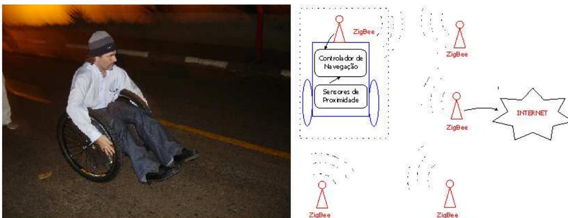
**Figura 1.32. Test-drive do Sistema de Mobilidade Autônomo Pessoal, constituído de uma cadeira de rodas motorizada, controlador de navegação embarcado e bases fixas na residência para auto-localização.**
