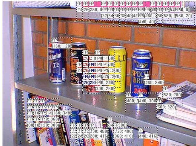
Figura 6. Exemplo de classificação com treino inicial da RNA para latas de Coca-Cola.
