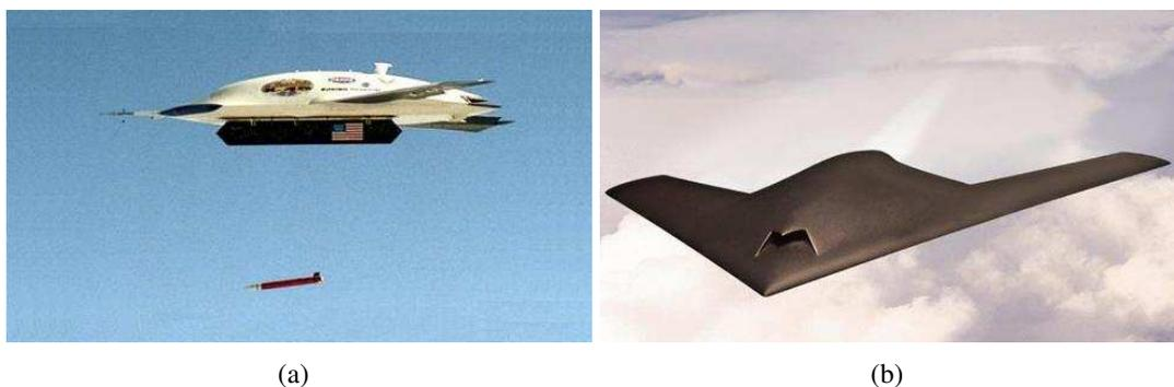
Figura 2.3: Robôs aéreos de combate: (a) Protótipo *X-45* americano (BOEING, 2007); (b) Protótipo *nEUROn* (DASSAULT, 2007), da comunidade europeia.
