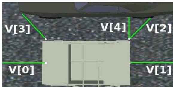
Figura 3.3: Distribuição dos sensores do tipo sonar no veículo usado do SEVA3D (OSÓRIO et al., 2006b).
