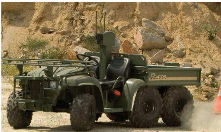
Figura 2.6: *R-Gator* (IROBOT, 2007), um veículo que permite tele-operação, navegação automática entre pontos tipo “ensinar-repetir”, desvio de obstáculos e operação manual.
