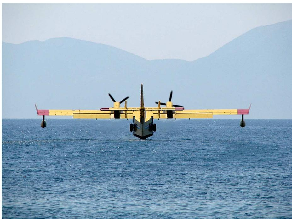
Figura 2.30: Avião-tanque *Canadair CL-415* (BOMBARDIER, 2007), transporta 6t de água, abastece sem pousar em uma superfície de água com 1,2km de comprimento e 2m de profundidade.
