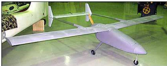
Figura 2.2: Aeronave automatizada brasileira, fruto do projeto *SiDeVAAN* (DEMEC/UFMG, 2007), para ser usada em pulverização de lavouras, inspeção de linhas de transmissão ou em missões de controle do espaço aéreo.
