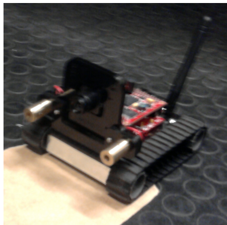
Figura 4.1: Robô Surveyor SRV-1Q utilizado no experimento.
