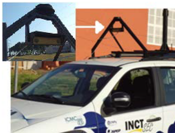
Figura 4.31: Posição da câmera bumblebee2 nos testes realizados.
