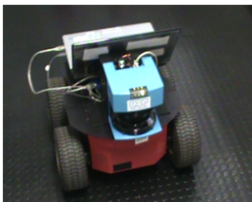
Figura 4.10: Robô Pioneer P3-AT com laser SICK usado no experimento.
