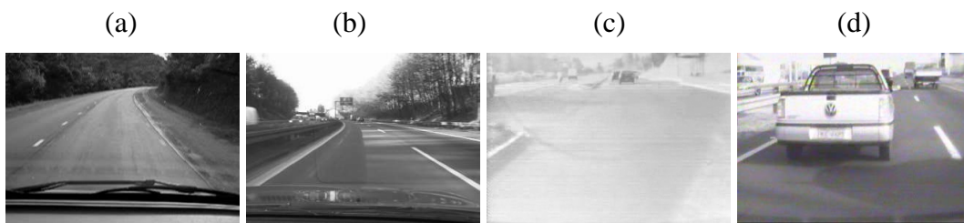
Figura 4.24: exemplos de fatores que dificultam a detecção das bordas da pista.
