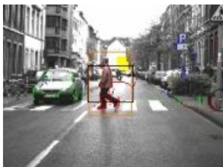
Figura 4.27: Exemplo de detecção de pedestres pelo sistema Protector
