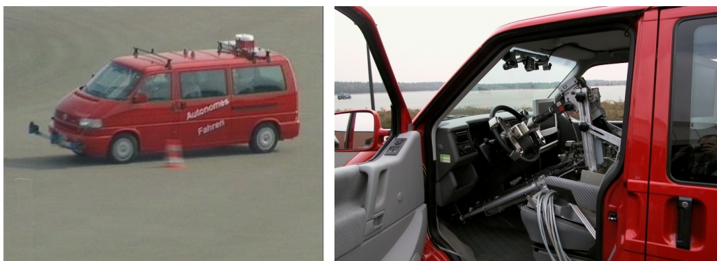
Figura 4.36: Projeto Autonomes Fahren (Volkswagen) – robô motorista
