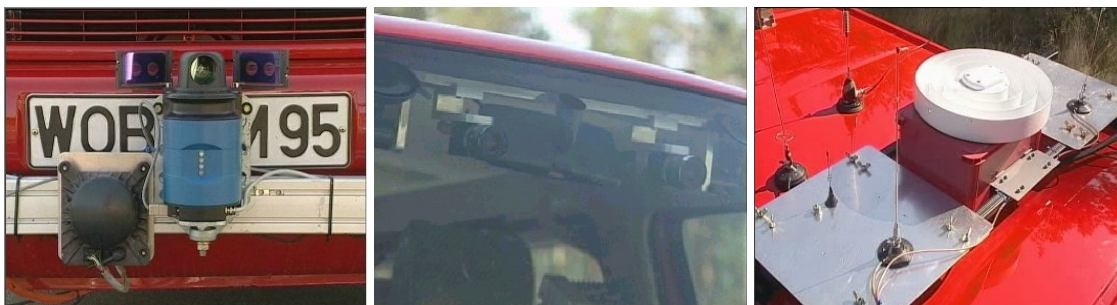
Figura 4.5: Radar, Scanner a Laser, Visão Estereoscópica, Plataforma Inercial integrada com GPS [Simon et al 2000]
