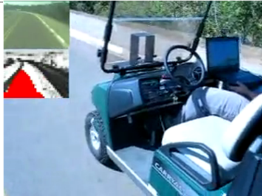
Figura 4.8: Veículo elétrico executando trajeto com o sistema implementado.
